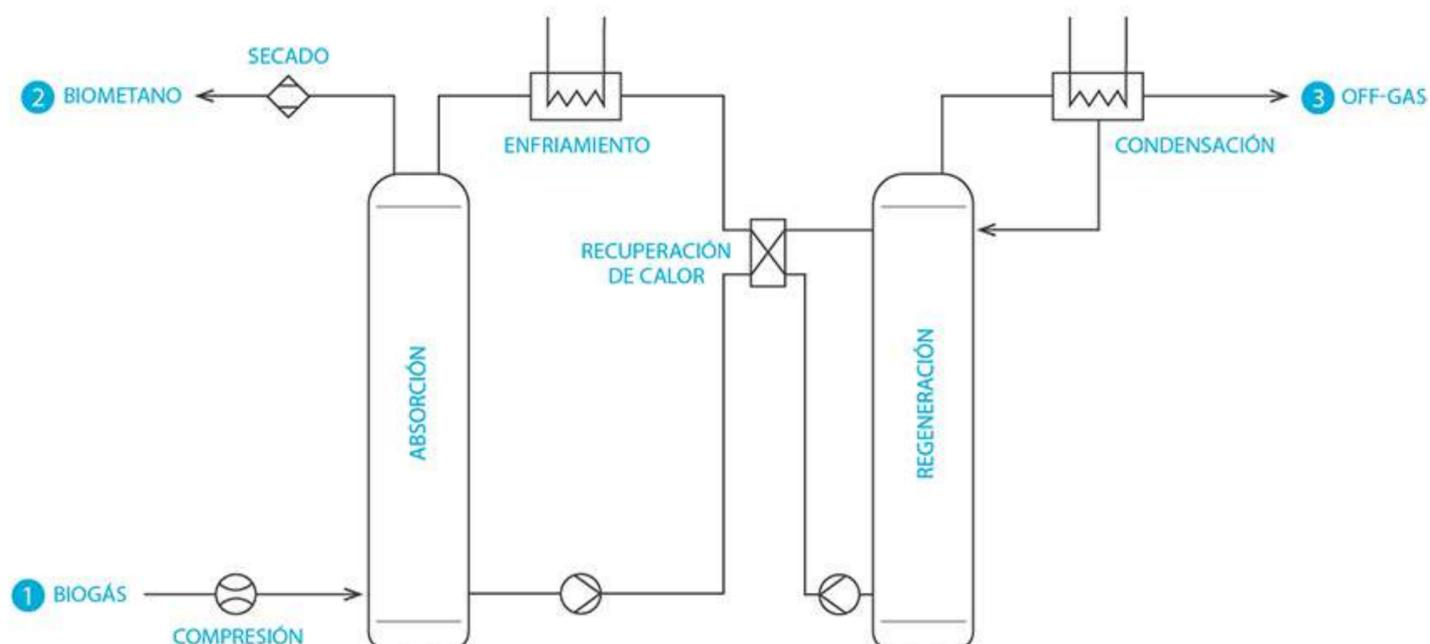
Esta tecnología está basada en la absorción química del CO<sub>2</sub>, el H<sub>2</sub>S y los compuestos orgánicos volátiles por parte de compuestos químicos como aminas o soluciones acuosas de sales alcalinas.
