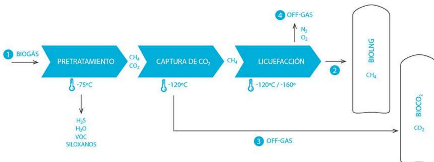
Los distintos puntos de ebullición del metano (-160°C) y del dióxido de carbono (-78°C) permiten separarlos mediante criogenización, recuperando el CO<sub>2</sub> en estado líquido. Este sistema resulta de especial interés para la generación de bioGNL por las condiciones de salida del biometano.
