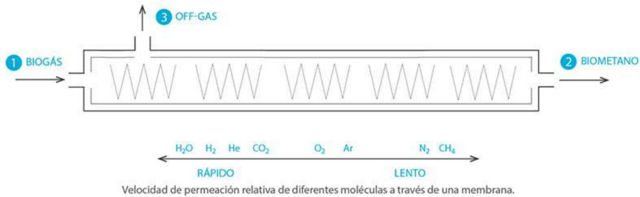
Mediante la presurización del biogás y su paso a través de membranas selectivas se consigue un biometano con un alto grado de pureza, que se puede optimizar encadenando varias etapas para purificarlo progresivamente. Se trata de un sistema intensivo en consumo eléctrico y modular. Aunque no presenta flexibilidad en cuanto al caudal a tratar se trata de una tecnología robusta ampliamente probada.
