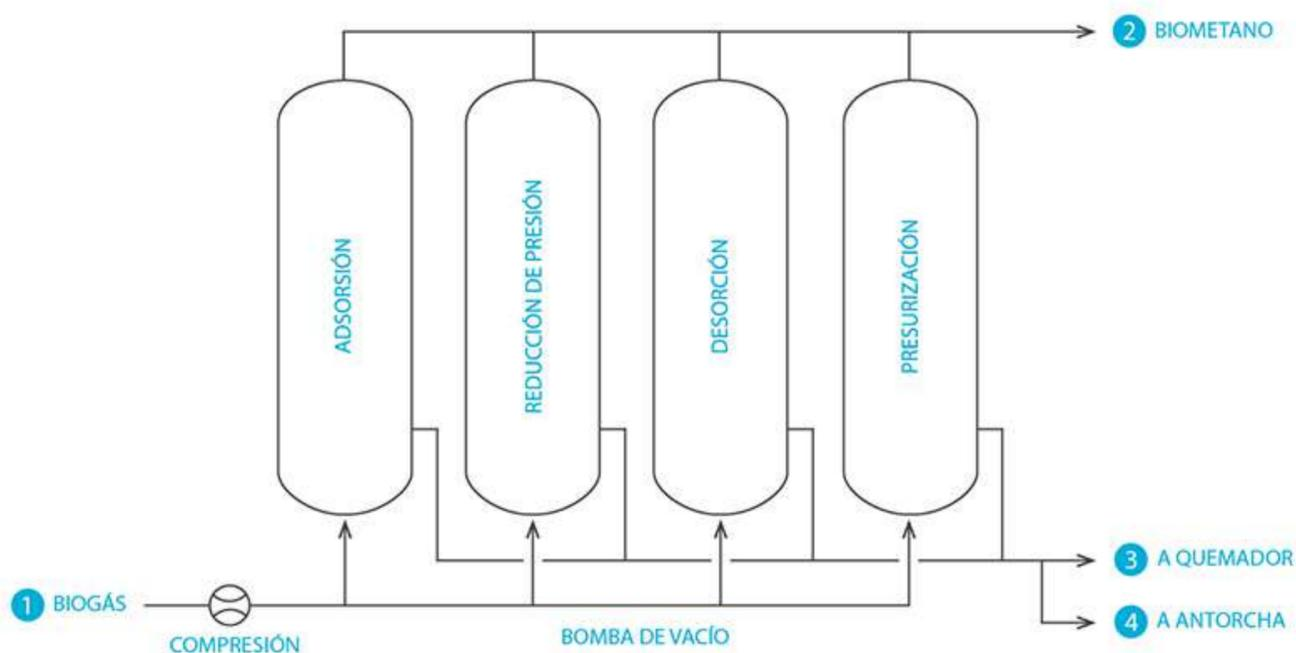
Ciertos materiales, como el carbón activo o zeolitas, tienen la capacidad de adsorber y desadsorber el CO<sub>2</sub> y esta propiedad se aprovecha en los sistemas PSA para purificar el biogás. El sistema consume energía eléctrica para conseguir los cambios de presión inherentes al proceso. Esta tecnología permite separar del metano prácticamente todo el O<sub>2</sub> y N<sub>2</sub>, hasta conseguir un biometano con alto poder calorífico.
