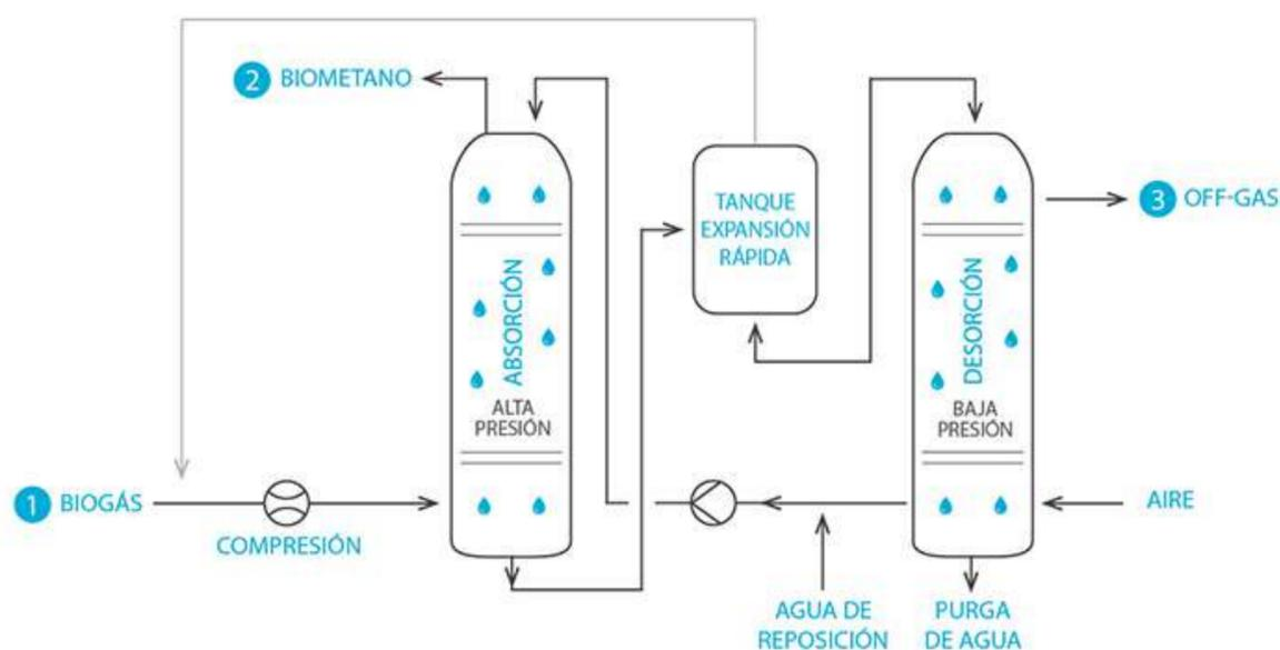
En el caso de esta tecnología la propiedad que se emplea para separar el metano y el CO<sub>2</sub> es la diferencia de solubilidad en agua de estos compuestos. El biogás pasa por un sistema de agua presurizada, de forma que, el dióxido de carbono queda disuelto en ella y el gas sale del proceso con un alto contenido en metano. Sin embargo, este biometano sale saturado y será necesario implementar un sistema de secado.
